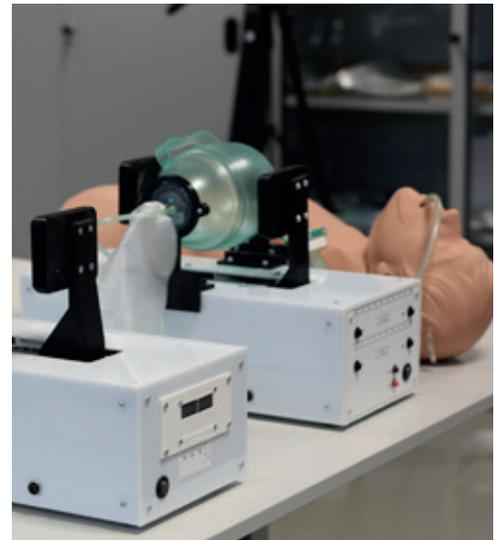
**Figura 2** - Semelhante a um ventilador de emergência e transporte, o dispositivo pode ser utilizado sem acesso à rede de energia elétrica (Foto: DR)
