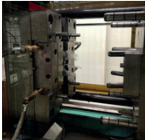
**Figura 5** – Molde de Injeção para produção de Conjunto Swivel.
