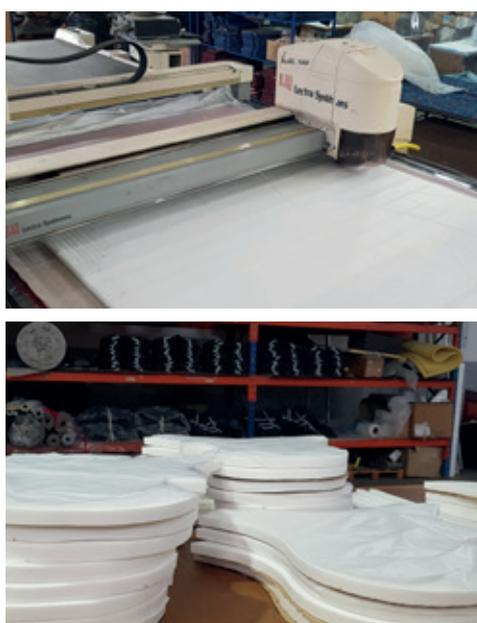
**Figura 1** – Confeção de cogulas de proteção.
