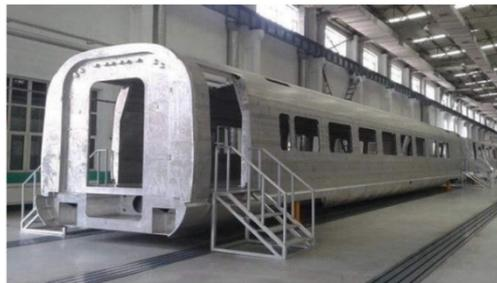
**Figura 1** – Carroceria típica de comboio de alta velocidade feita em liga de alumínio.
