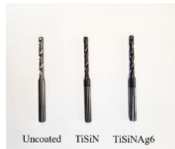
Figura 2 – Aspeto visual das brocas pós deposição dos revestimentos
