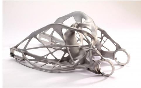
**Figura 7** - Braço oscilante, produzido numa moldação em areia obtida por manufatura aditiva [25].
