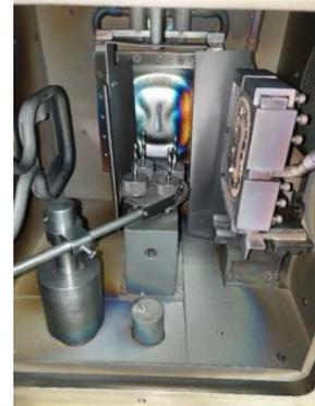
Figura 1 - Deposição dos revestimentos TiSiN(Ag) em brocas
