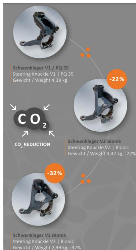
**Figura 2** - Exemplo da redução de peso de um *steering knuckle* pela aplicação de ligas de alto silício e otimização de design [12].
