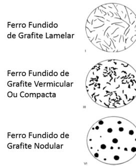
**Figura 1** - Morfologia das partículas de grafite nas três principais classes de ferro fundido, ISO 945-1:2017.
