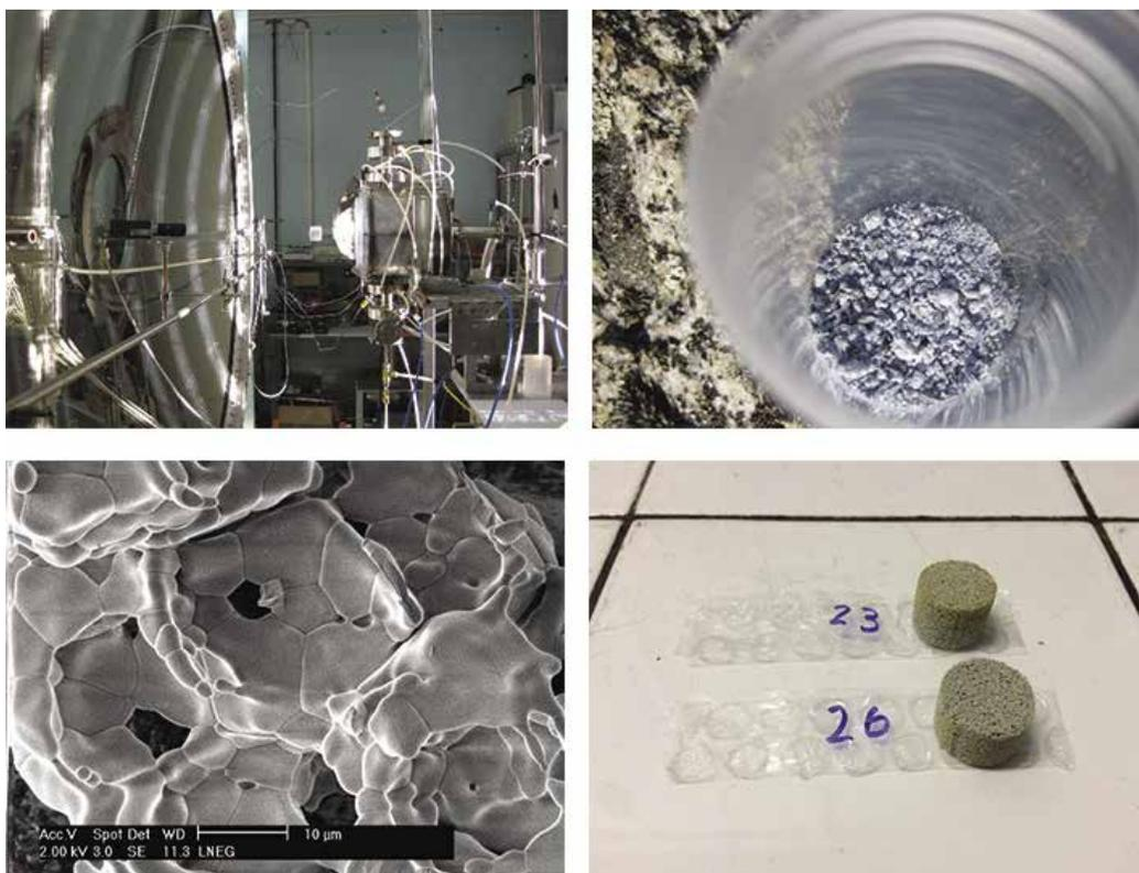
Figura 7. Instalação para a separação de moléculas de água e dióxido de carbono, pela via termoquímica solar, usando radiação solar concentrada como fonte de aquecimento, do PROMES-CNRS; (a) vista geral do forno solar e respectivo reactor, (b) grânulos de céria após ensaio, (c) microestrutura dos grânulos de céria desenvolvidos na Universidade de Aveiro e (d) espumas de céria após ensaio.
