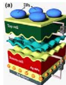
Figura 1 – Representação da tecnologia fotovoltaica desenvolvida no projeto AltaLuz: esquema da célula solar tandem de dupla junção e 4 terminais.
