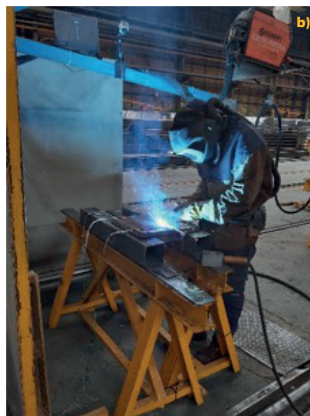
Figura 1 – Ensaios experimentais executados no decorrer do projeto: a) Otimização dos parâmetros do processo de Oxicorte; b) Ensaio de Soldadura MAG com monitorização da temperatura.
