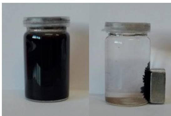
Figura 2- Separação magnética das partículas nanoadsorventes da água usando um magnete [6].
