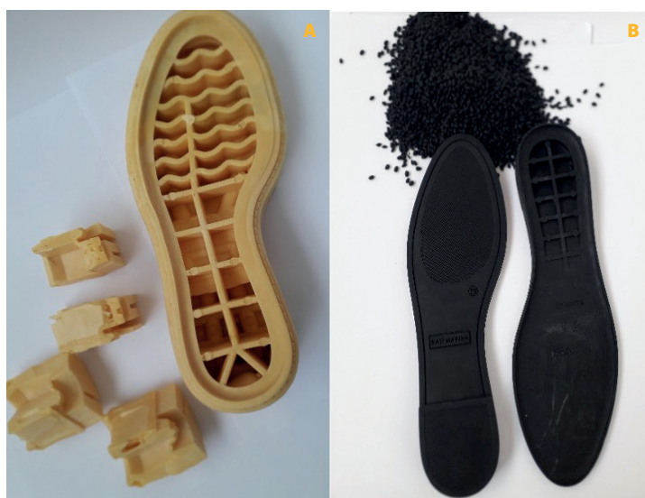
Figura 1: Solas produzidas com os compostos: A) TPU + AC; B) SEBS + microesferas
