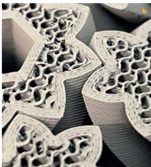
Figura 4: Planetário fabricado por MEX, usando DfAM (a), com detalhe das estruturas utilizadas (b).
