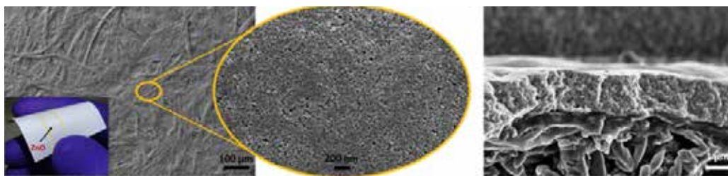
Figura 2 – Imagens de microscopia electrónica de camadas de nanopartículas de óxido de zinco “escritas” sobre papel (vista de topo à esquerda e imagem em secção à direita).
